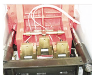
ŚRODKOWY TŁOK ZABLOKOWANY (W TEJ POZYCJI DWA KĘSY JEDNOCZEŚNIE).
